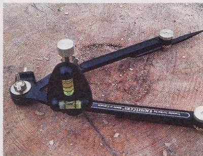
Скрайбер оснащён пузырьковыми уровнями, помогающими удерживать инструмент в нужных плоскостях.
