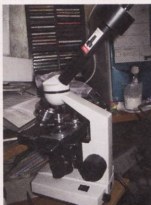
Камера вставлена вместо окуляра и подключена к компьютеру.
