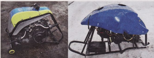
Моторный модуль, где помимо двигателя размещён бензобак, аккумулятор, рулевой вал (для удобства транспортировки и погрузки устанавливаются специальные колёса, а руль с фарой и щитком снимаются). К моторному модулю во время сборки снегохода крепится подрамник с сиденьем.
