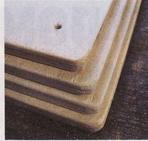
Полки, вырезанные из фанеры, тщательно зашкуриваются.
