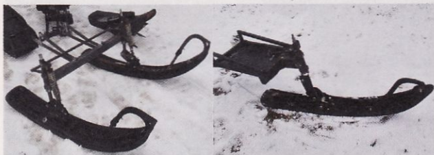
Лыжные модули с двумя и одной управляемой лыжей (для удобства транспортировки, погрузки и хранения лыжи снимаются).
